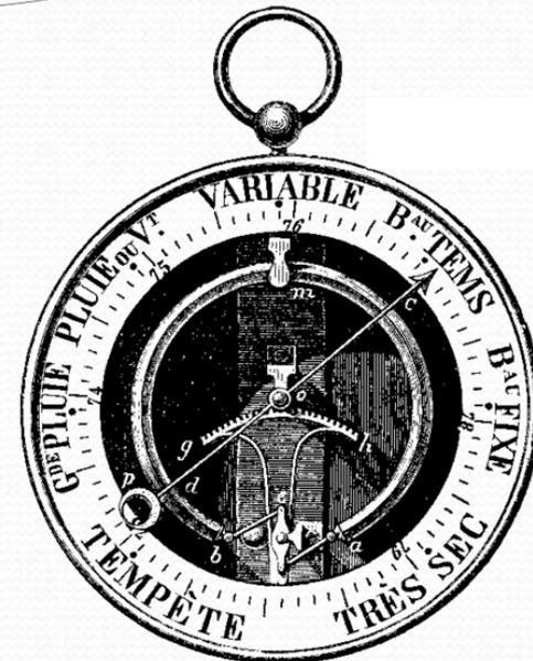
Fig. 283. — Baromètre de Bourdon.
